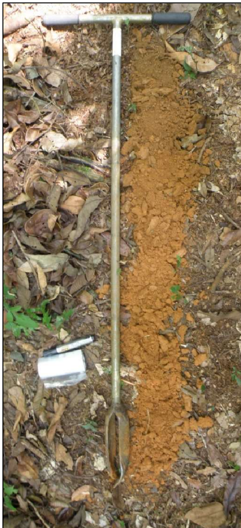
Figure 4 : Sondage réalisé sur le terrain à la tarière à main après prélèvement des échantillons
